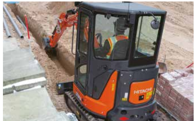
Dank des kleinen Heckschwenkradius ist der ZX33U-6 ideal für Arbeit auf engem Raum.
