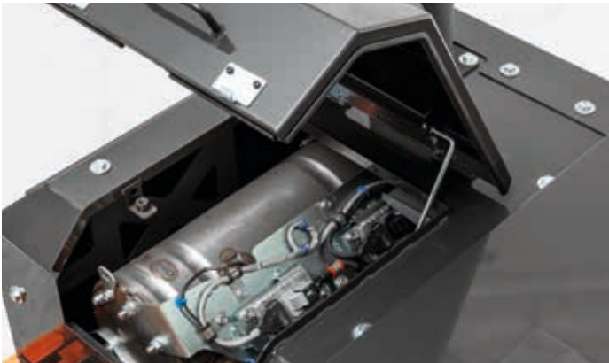
Die Wartungsintervalle des neuen katalytischen Dieselpartikels wurden deutlich verlängert.
