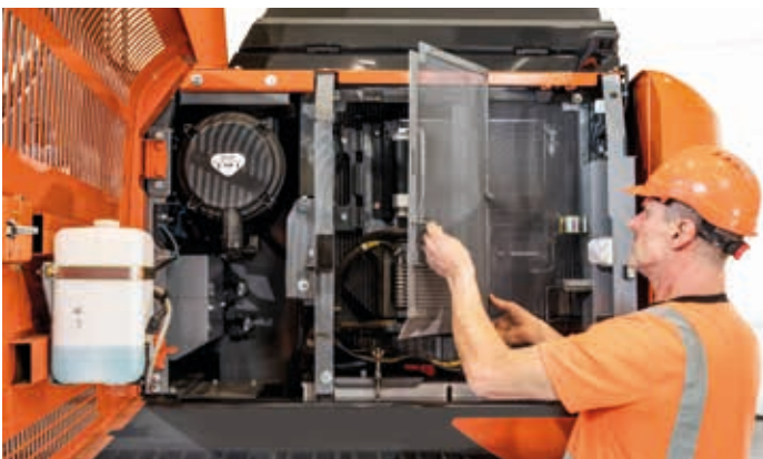
Einfache Wartungszugänge sorgen für minimale Ausfallzeiten.
