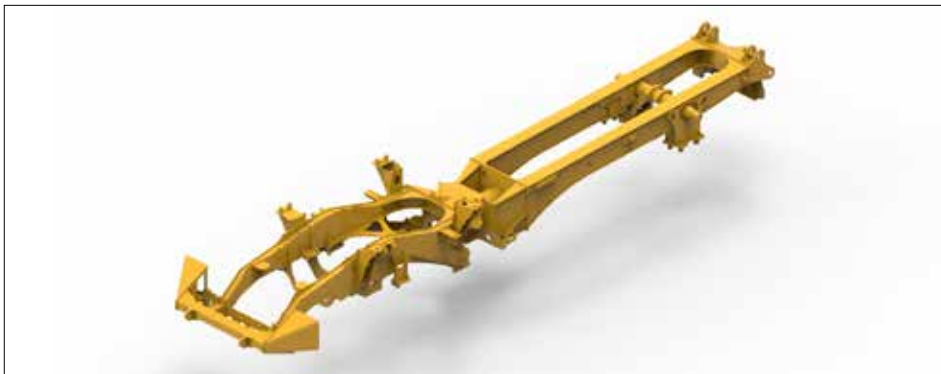
Der Rahmen aus hochfestem Stahl bringt Stabilität und Robustheit ohne Mehrgewicht.
