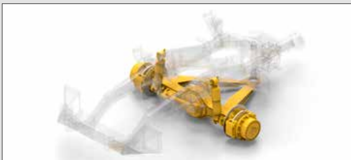
Für besseren Arbeitskomfort reduziert die A-Rahmen-Aufhängung mit hydro-pneumatischen Dämpfern die häufig im Off-Road-Betrieb auftretenden seitlichen Schwingungen. Eine wirkungsvolle Federung des Fahrersitz schützt den Fahrer zusätzlich.
