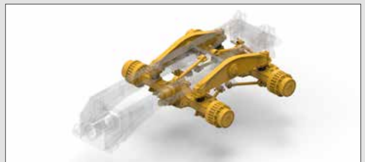
Schweres Gelände erfordert eine wirksame Fahrzeugfederung. Hochwertige Komponenten absorbieren Stoßbelastungen und optimieren die Fahreigenschaften durch überdurchschnittliche Federwege und Bodenfreiheit.
