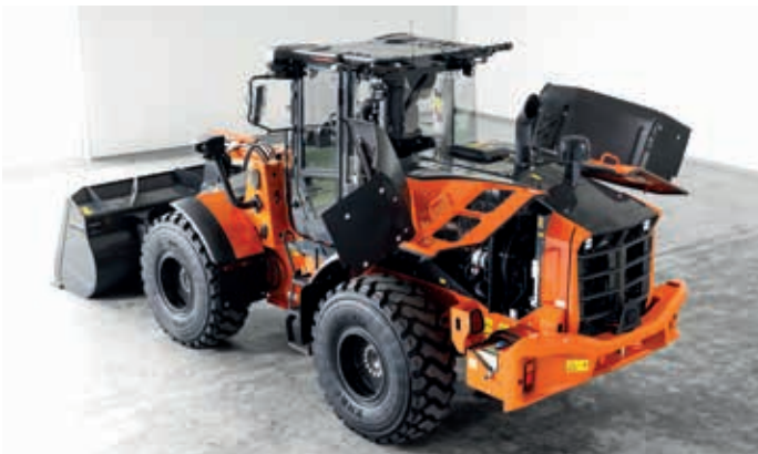
Die Motorabdeckung ermöglicht einen leichteren Zugang für tägliche Inspektionen.
