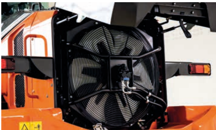
Inteligentny system sterowania wentylatorem zapobiega zapychaniu chłodnic.
