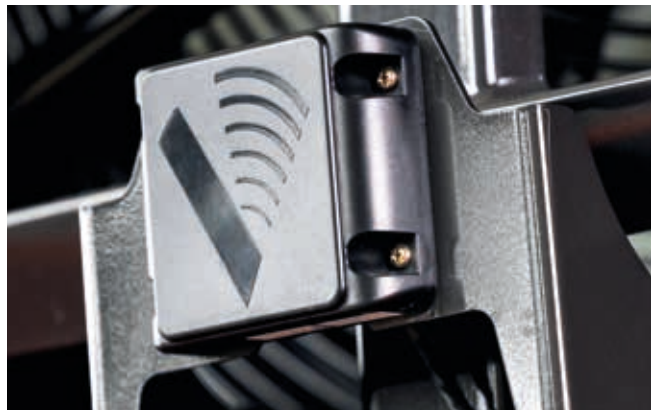
Tylny system wykrywania przeszkód zwiększa bezpieczeństwo w miejscu pracy.
