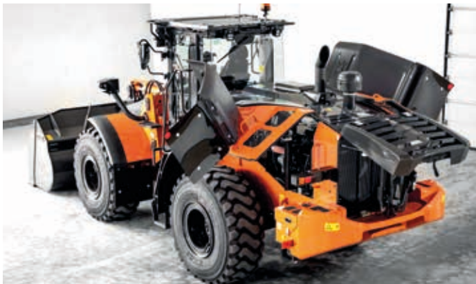
Pokrywa silnika zapewnia wygodny dostęp w celu przeprowadzania codziennych kontroli.
