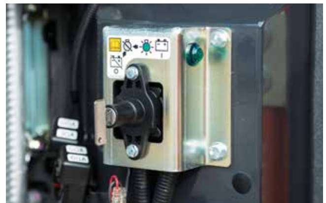
Wyłącznik akumulatora umożliwia bezpieczne wykonywanie konserwacji.
