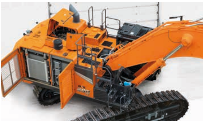
Podzespoły zapewniają wygodny dostęp w celu codziennej konserwacji.
